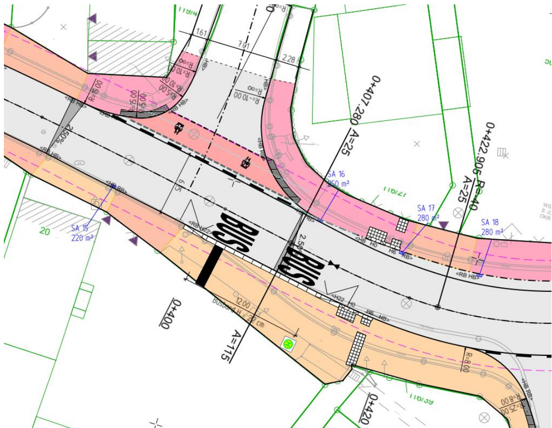
Abbildung 19: Detail Variante 4 - Gestaltung Fahrbahnrandhaltestelle
