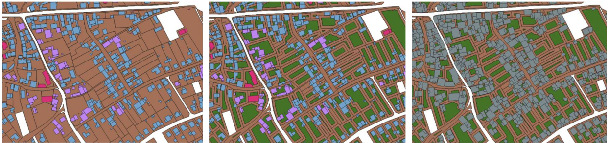
Abbildung 19: Prinzipdarstellung zur Ermittlung verfügbarer Flächen für dezentrale Sondenbohrungen
